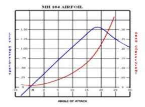
**Figure: 4** (Co-Efficient Of Lift Vs Co-Efficient Of Drag)
